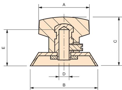
Insert en laiton borgne percé avec blocage latéral par vis acier.
