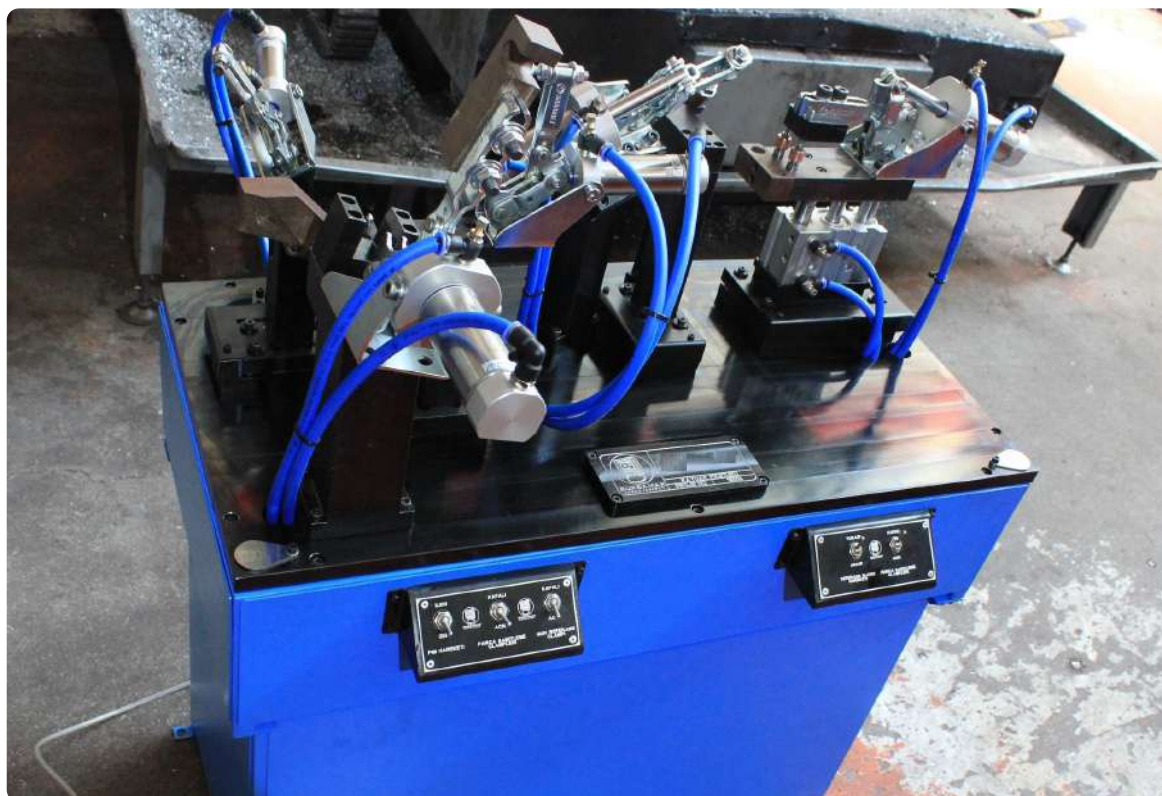
Cilindrico pneumatico a doppia azione, magnetico e con ammortizzatore Vérin à double effet : magnétique et avec amortisseur
